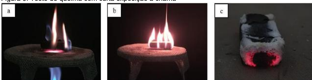
Figura 9. Teste de queima com curta exposição à chama
