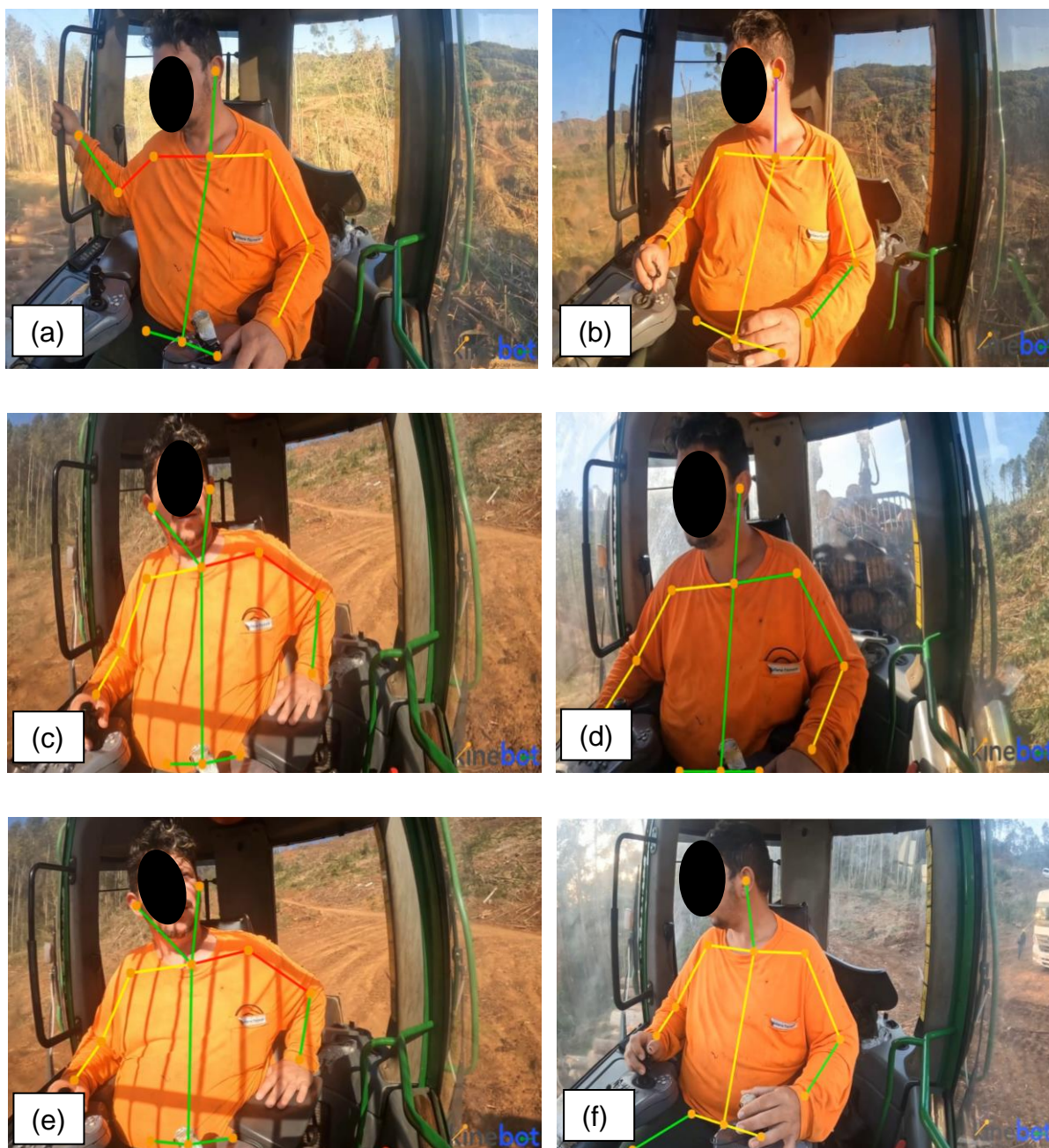
Figura 24. Posturas típicas adotadas pelo operador de forwarder na extração da madeira. Sendo: Deslocamento vazio (a), Carregamento da tora na pilha (b), Carregamento da tora na caixa de carga (c), Deslocamento carregado (d), Descarregamento retirando a tora da caixa de carga (e), Descarregamento colocando as toras na pilha (f).
