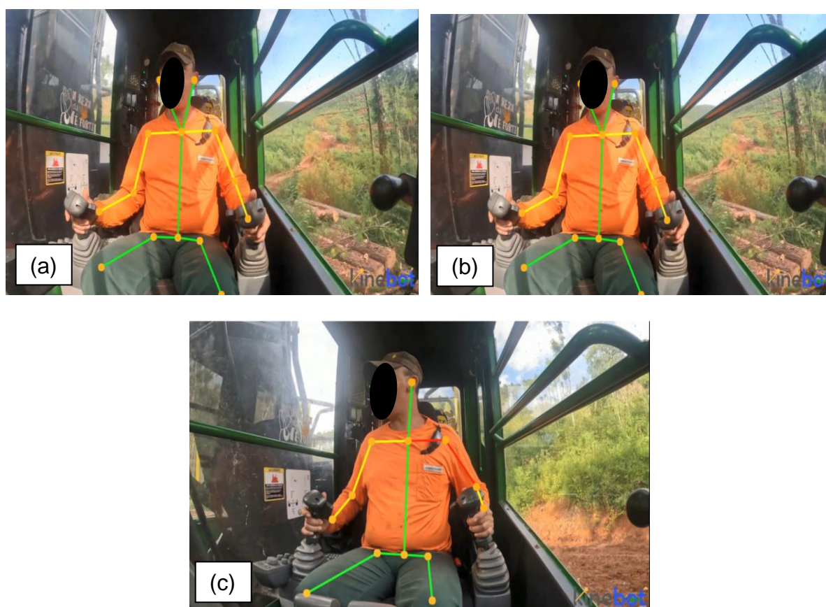
Figura 22. Posturas típicas adotadas pelo operador harvester na operação de corte. Sendo: Deslocamento (a), Busca e Corte (b) e Processamento (c).
