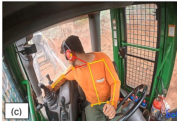
Figura 11. Exemplo do processamento da avaliação postural pelo software Kinebot®. Sendo: Harvester (a); Forwarder (b) e Skidder (c).
