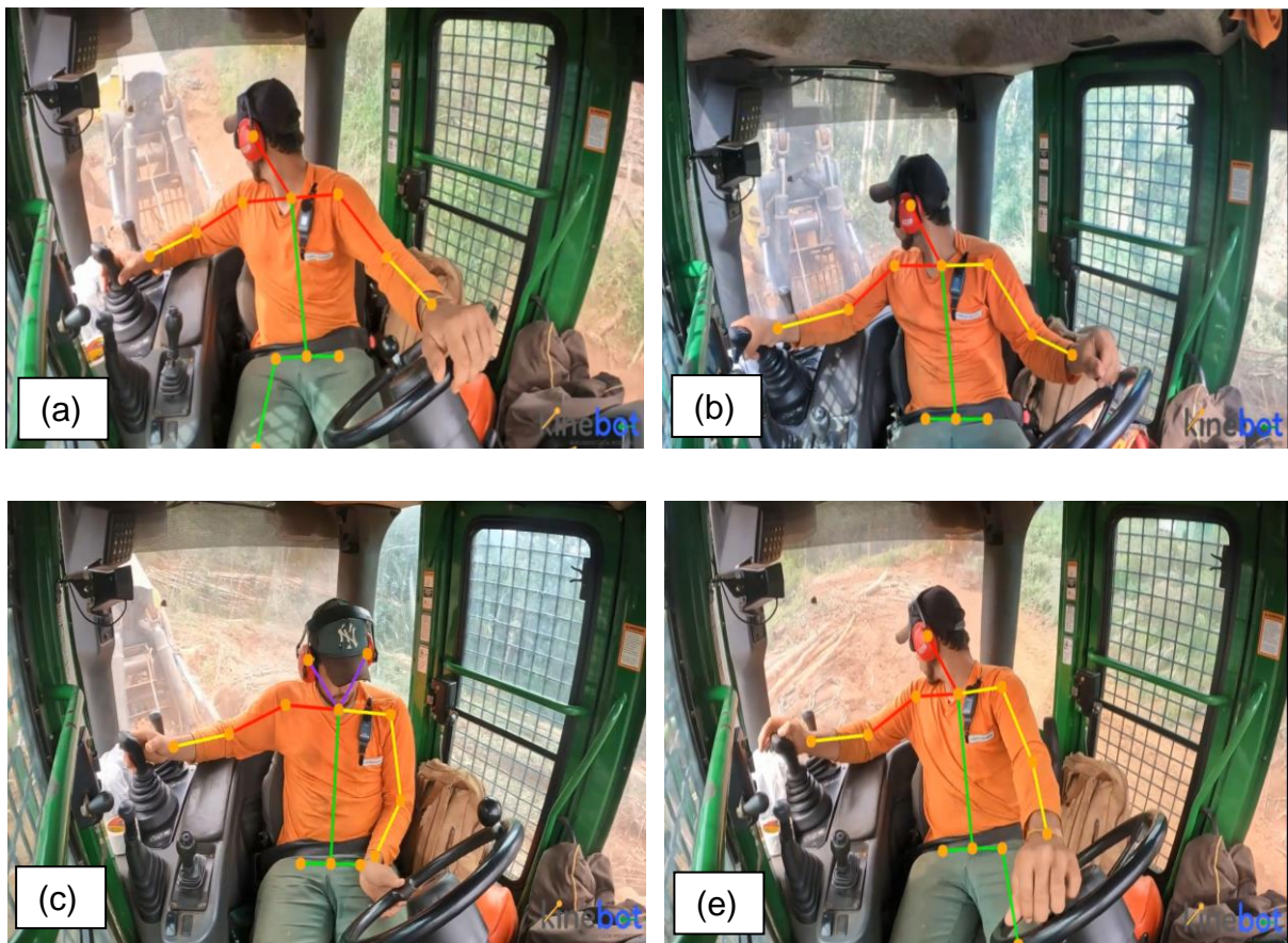
Figura 26. Posturas típicas adotadas pelo operador de skidder na extração de madeira. Sendo: Deslocamento vazio (a), Carregamento dos feixes (b), Deslocamento carregado (c), Descarregamento dos feixes (d).
