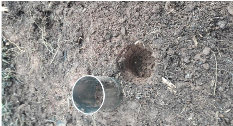
Figura 6. Coleta de solo utilizando Anel Volumétrico.
