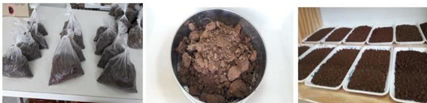
Figura 8 - Recepção, peneiramento e secagem das amostras no laboratório.
