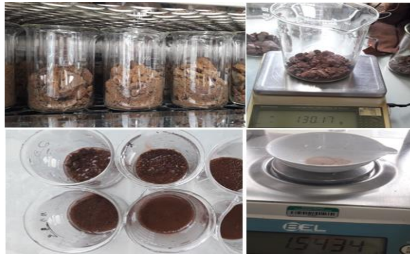
Figura 9 – Secagem, pesagem e determinação do teor de areia das amostras.
