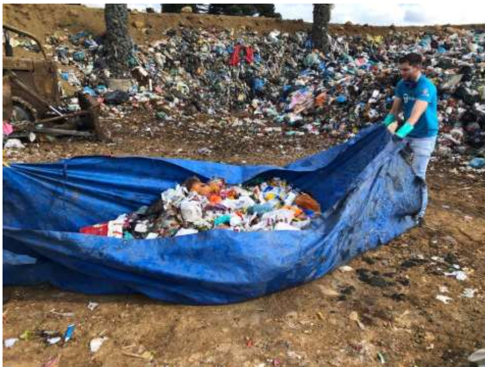
FIGURA 10 – MISTURA MANUAL DOS RESÍDUOS JÁ FORA DAS SACOLAS PLÁSTICAS
