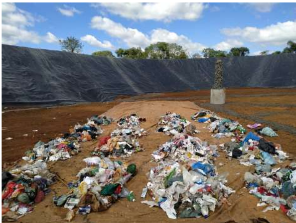
FIGURA 13 – PROCESSO DE QUARTEAMENTO
