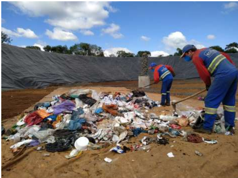
FIGURA 09 – MISTURA DOS RESÍDUOS SOBRE UMA LONA PLÁSTICA PARA OBTENÇÃO DE UMA AMOSTRA HOMOGÊNEA
