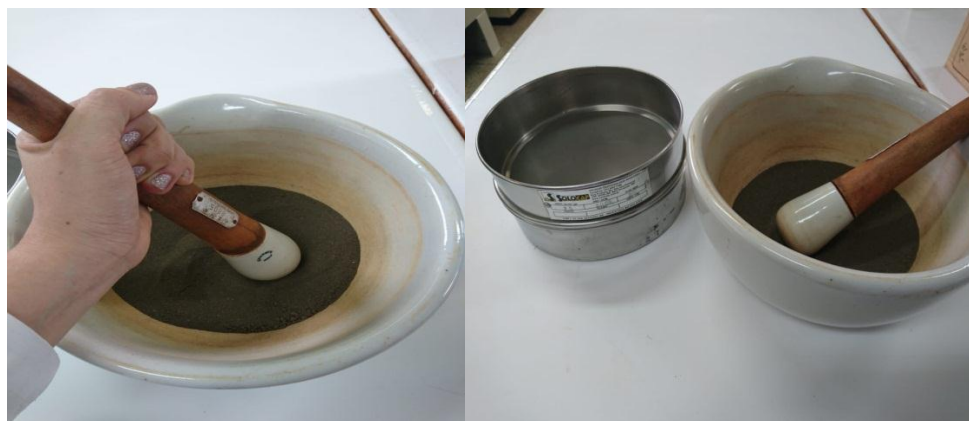
Figura 8 – Amostras de lodo maceradas para em seguida serem peneiradas
