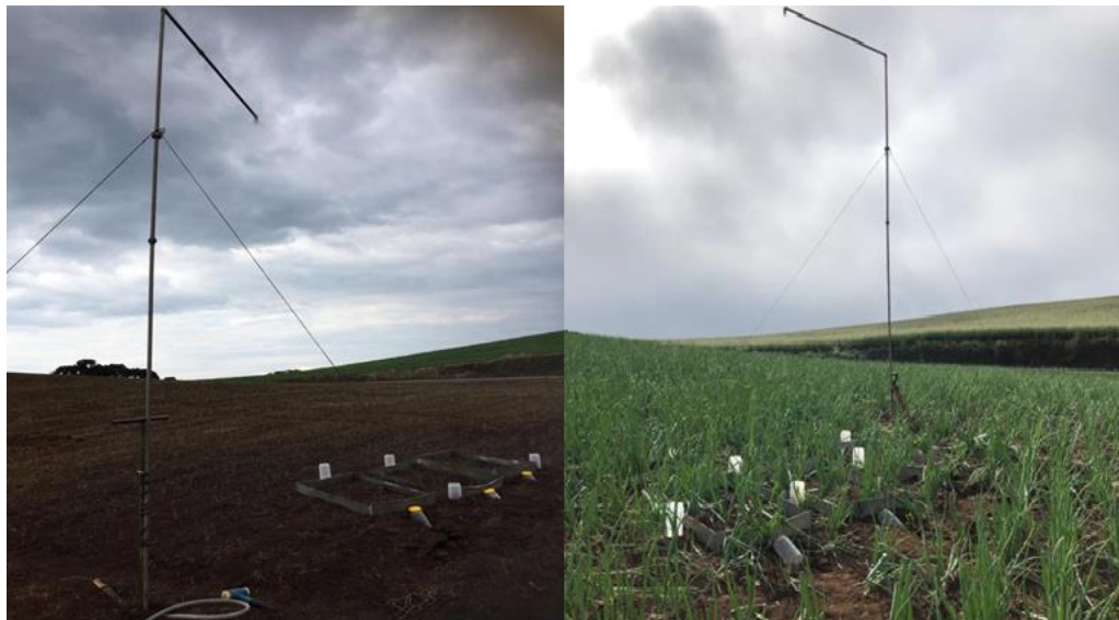
Figura 4. Características do simulador de chuva instalado em campo durante a simulação
