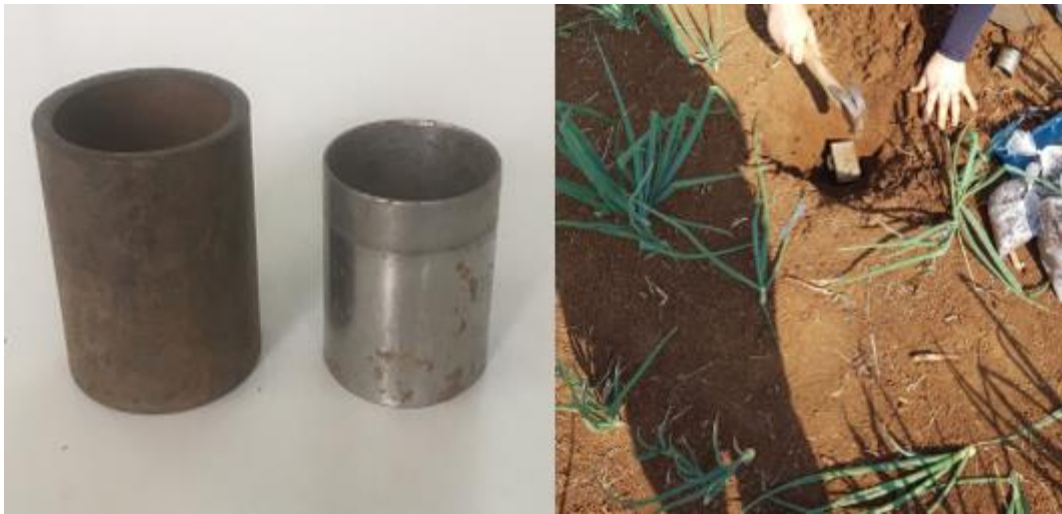
Figura 2. Método de coleta do solo com anel volumétrico.
