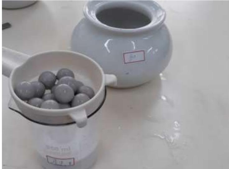
Figura 13 - Suspensão sendo separada das esferas após tempo de agitação. (Do autor).
