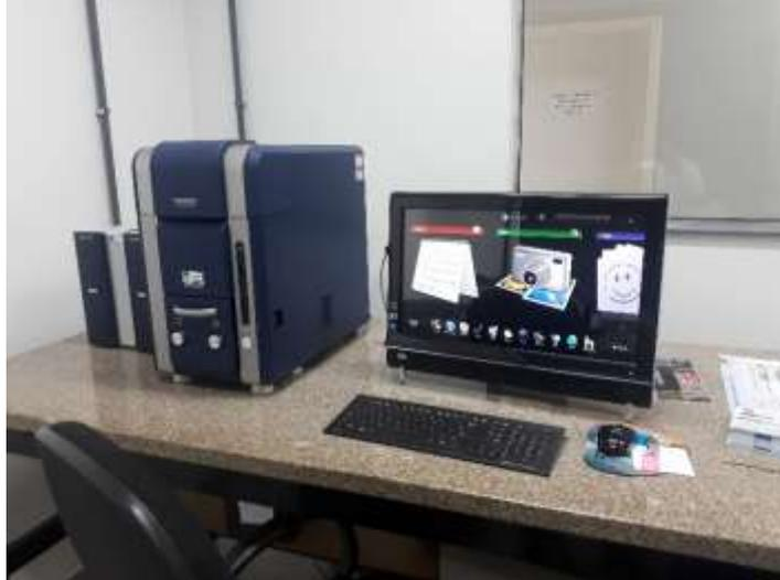
Figura 16 - Equipamento de Microscopia Eletrônica de Varredura (MEV) e Espectroscopia de raios x por dispersão em energia (EDS). (Do Autor).
