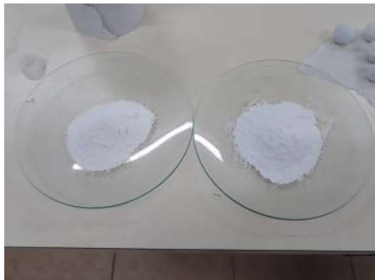
Figura 14 - Pó alvo obtido após a secagem em estufa, 60°C durante 24 horas. (Do autor).
