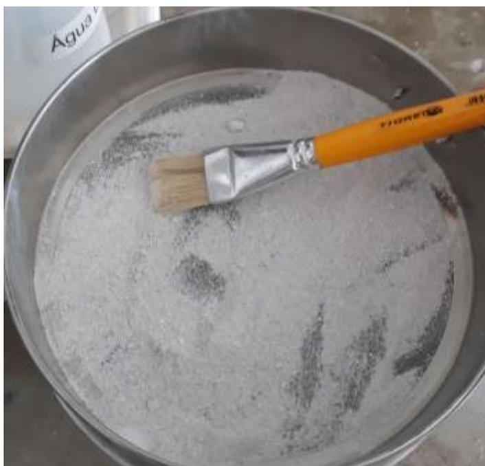
Figura 8 - Processo de diminuição de tamanho de partícula com peneira. (Do autor).
