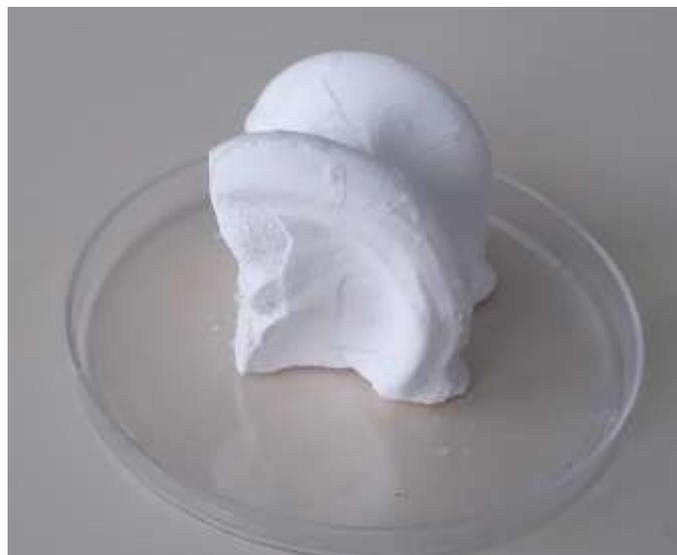
Figura 6 - Osso após a calcinação em 850°C. (Do Autor).
