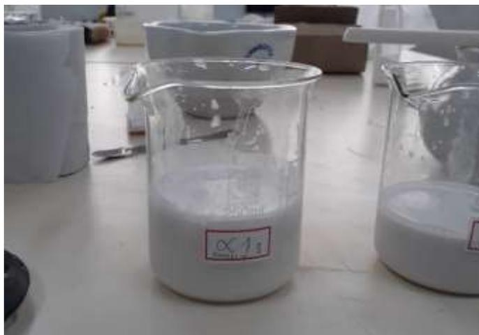
Figura 12 - Suspensão preparada com água destilada e HAp. (Do autor).
