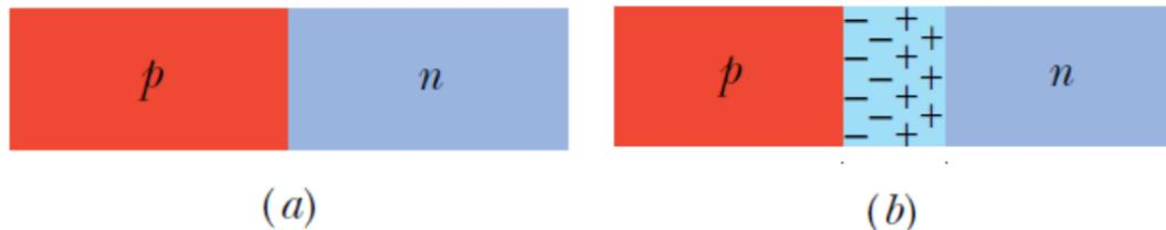
Figura 2 – Representação de uma junção PN (a) e a zona de depleção (b). Adaptado de: 11.
